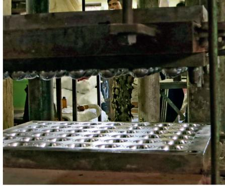
Der erste Schritt zum Tennisball: In diesen Formen werden die Halbkugeln aus Kautschuk hergestellt.
