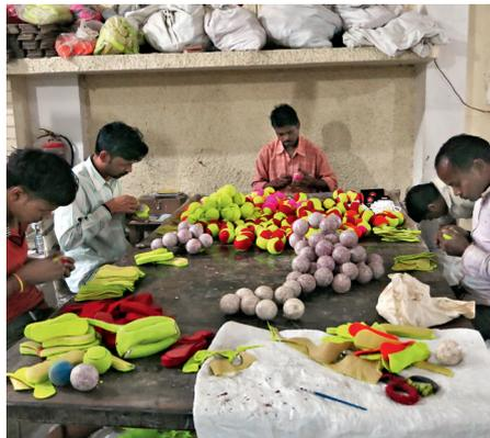
Die gestanzten Filzstücke werden auf die fertigen Naturkautschukbälle aufgeklebt.
