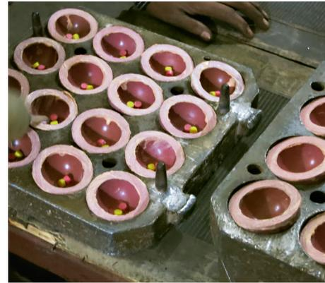
Hier werden die Halbkugeln mit chemischen Substanzen gefüllt, die nach dem Zusammenkleben der Hälften unter heißem Dampf reagieren und dadurch einen höheren Druck im Ball aufbauen.
